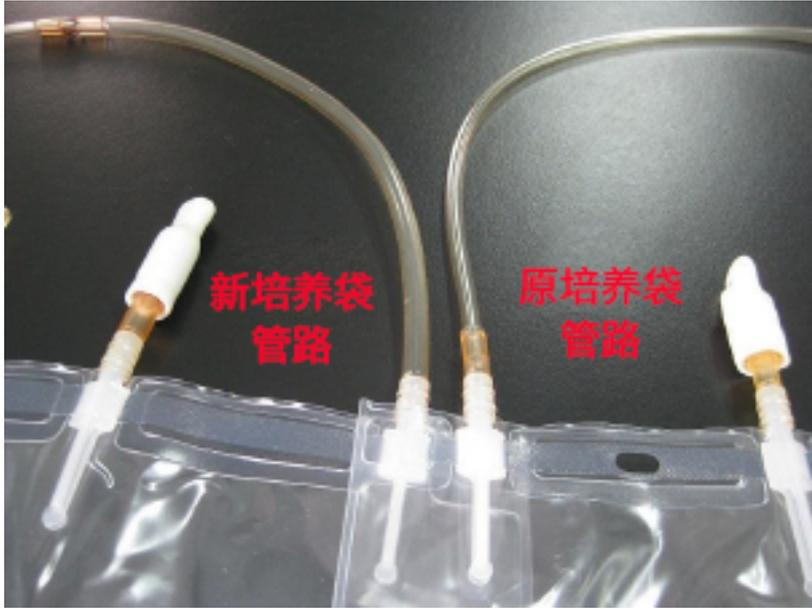
更改后的培养袋管路进液速度提高35%，出液速度提高65%。
