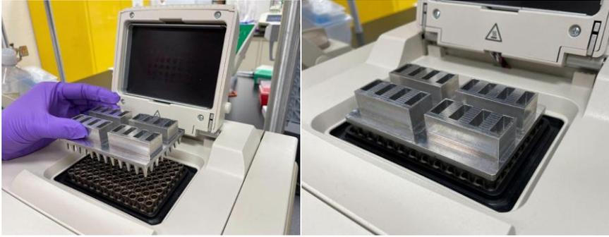
图 5. Seeker 反应室适配器放入 PCR 仪中
